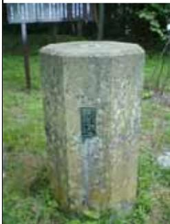
天文測量における経緯度観測は、当初は測地原点を決定する際あるいは、離島などの測地網から独立した地域での位置確定の時に実施された。そのような測量を経て測地網が完成した後は、主に網の規正のために天文測量が実施された。星(恒星)を観測して座標(経度、緯度)を決める測量(天文測量)に使用した天測点は、昭和26年から昭和33年の5年間で全国に48点を設置した。設置された当時の観測機器は大変に重く、観測台が必要であった。そのため、わざわざ観測台を持ち運ぶこともなく、さらに繰り返し測量にも便利のように天測点が設置された。その後機器の改良により軽量化が計られた為全国の三角点上で、天文測量を実施することになり、天測点の役割はわずかの期間だけに使用されただけであった。
